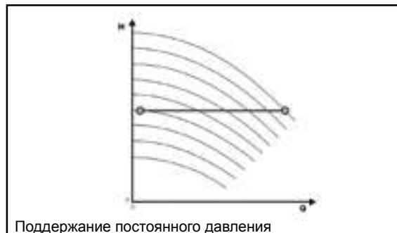
Поддержание постоянного давления
